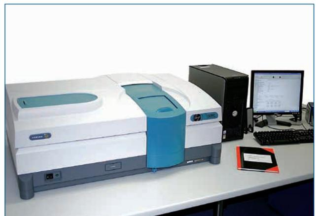
Espectrofotómetro de alta gama en el laboratorio de calibración de optek
