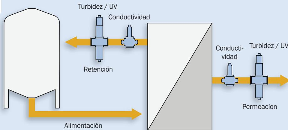
En un proceso típico de UF, se consideran generalmente dos puntos de instalación.
