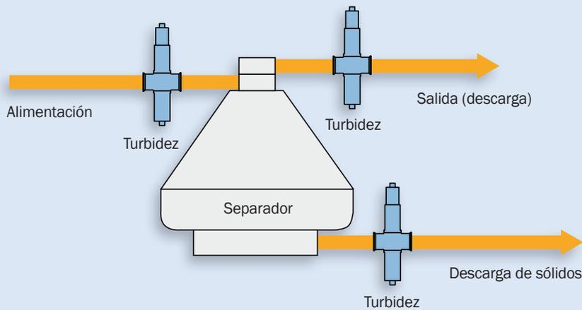
La instalación de sensores optek en la entrada y en la salida de una centrífuga hace que mejore considerablemente el proceso de la separación, reduciendo pérdidas y mejorando la consistencia del producto.
