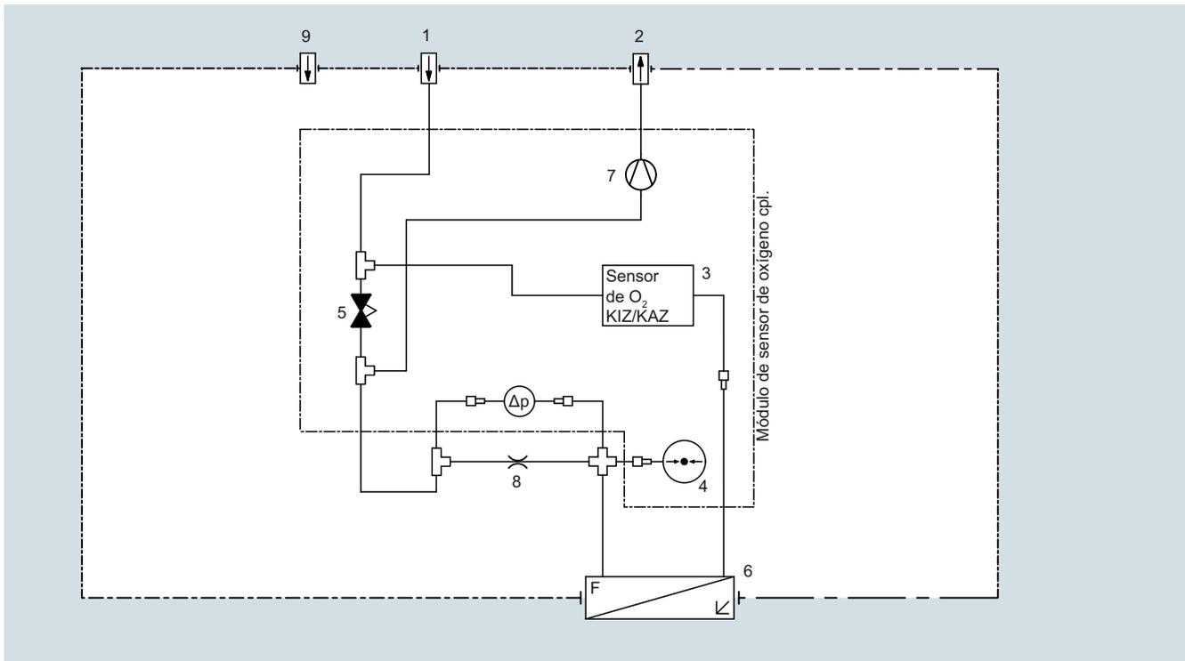
Variante de baja presión con bomba de gas de muestra incorporada
