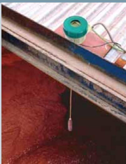
El sensor Pointek CLS300 constituye una solución fiable y precisa para operaciones seguras y económicas bajo condiciones de proceso rudas con solicitaciones químicas y físicas. Es idóneo para detección de nivel de llenado alto o bajo, o como complemento de instrumentos de medida continua de nivel en procesos con presiones y temperaturas elevadas.
