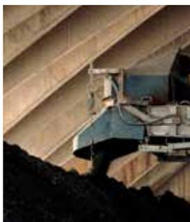
Monitorización remota fiable de sólidos polvorientos? El haz estrecho de emisión del transmisor de nivel SITRANS LR560 es una solución óptima para ambientes polvorientos.
