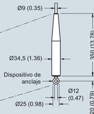
SITRANS LC300 conexiones de proceso roscadas, dimensiones en mm (inch)
