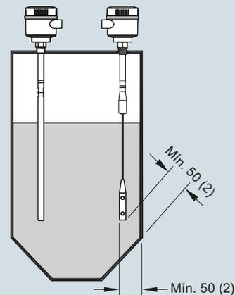
Mantener una distancia mínima de 50 (2) entre la sonda y la pared del depósito. Tomar en cuenta el ángulo de reposo del material.
