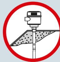
La acumulación de producto o la condensación en la protección active shield no afecta al funcionamiento del detector.
