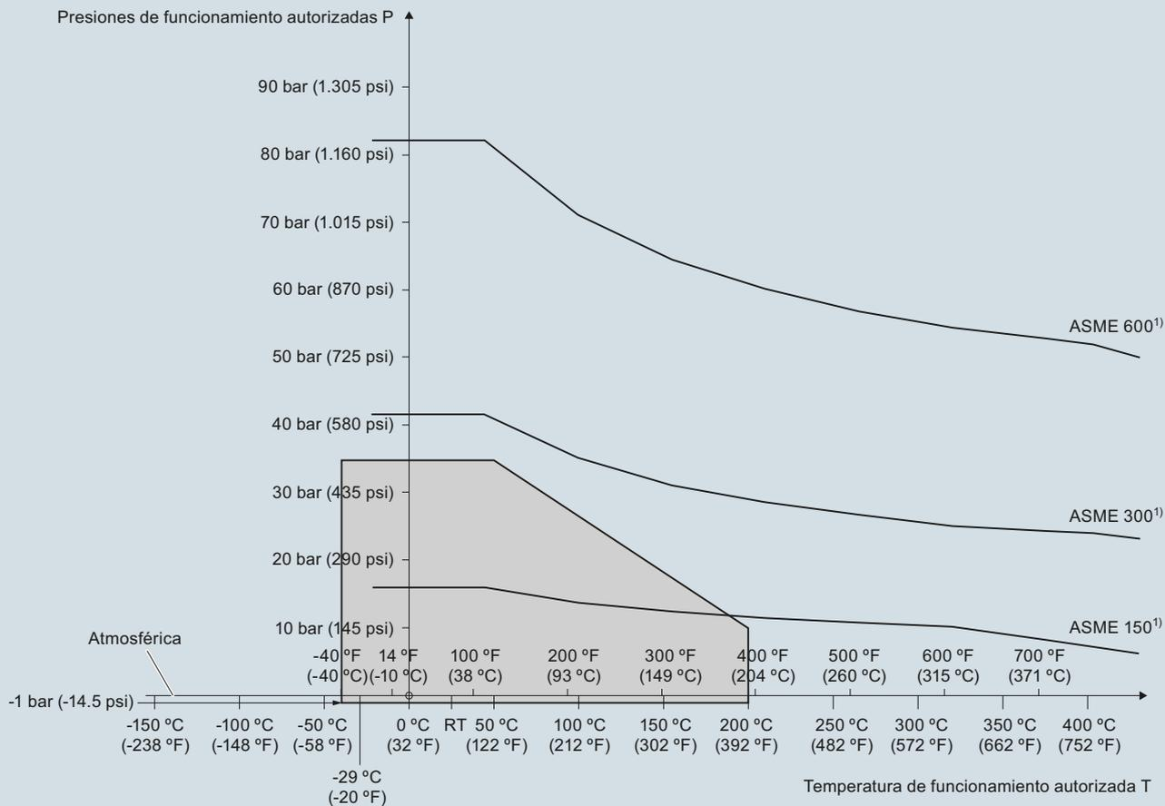
Curvas de reducción presión/temperatura de proceso SITRANS LC300 (7ML5670, 7ML5671, 7ML5672 y 7ML5673)
