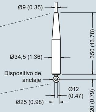
SITRANS LC300 conexiones de proceso bridadas, dimensiones en mm (inch)
