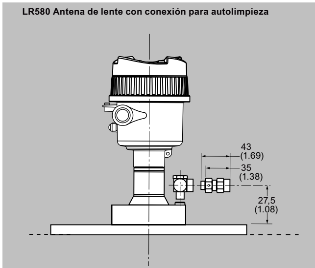
SITRANS LR580 Antena de lente con conexión para autolimpieza, dimensiones en mm (inch)
