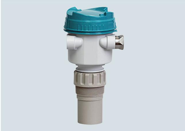
El transmisor ultrasónico de nivel SITRANS Probe LU240 con HART y 4 a 20 mA está diseñado para la medición de nivel, volumen y caudal volumétrico de productos líquidos, lodos y materiales a granel en rangos hasta 12 m (40 ft).
