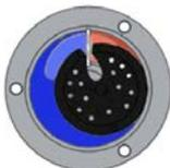
3- La entrada del líquido va llenando de forma progresiva la cámara de medida de entrada (rojo) a la vez que se empieza a vaciar la cámara de salida (azul). A la mitad del ciclo (punto de la figura), las dos cámaras tienen el mismo tamaño.
